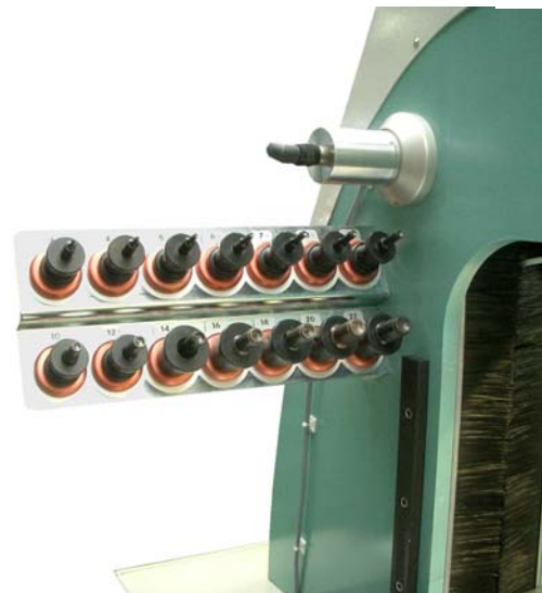
Werkzeugträger mit codierten Werkzeughaltern
